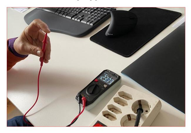
Mit der Hand auf der Erdungsmatte erreichen wir immerhin einen Wert von 763 Millivolt. Es ist jetzt lediglich das 3fache des baubiologischen Grenzwertes - statt des 90fachen Grenzwertes (Wir haben der Fa. empfohlen, einen kundigen Elektriker hinzuzuziehen, der eine Grundprüfung der Erdung vornimmt bzw. prüft, wie der Ausgangswert vermindert werden kann.)
